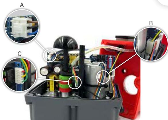
Desconectar el cableado de la tapa que está conectado a la electrónica. (Fig. A, B y C).
