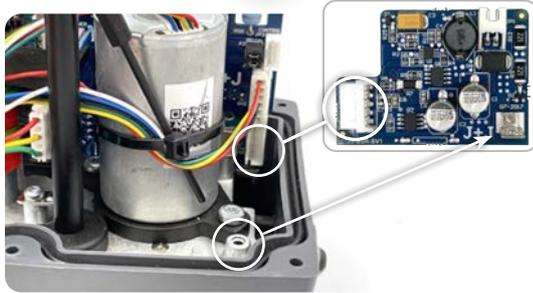
Enchufar la electrónica BSR (Pieza A) a la electrónica del actuador mediante el conector señalado en la figura.
