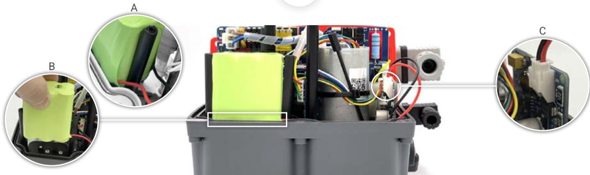
Encajar la batería (Pieza C) en el soporte inferior batería (Pieza B) (Fig. B). Los cables de la batería deben quedar en la parte inferior. Situar los cables según imagen (Fig. A). Conectar los cables de la batería a la electrónica BSR (Pieza A) (Fig. C).
