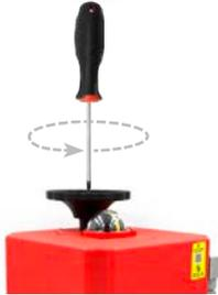
Desatornillar el tornillo que fija el volante y retirarlo.
