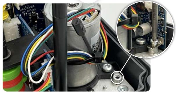
Fijar la electrónica a la chapa metálica del actuador, mediante un tornillo rosca chapa (Pieza E).
