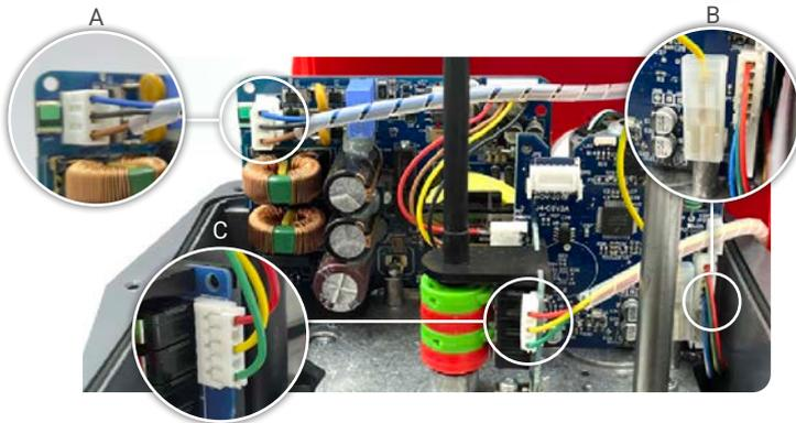
Coger la tapa del kit DPS (**Pieza A**) y conectar el cableado según (Fig. A, B y C).
