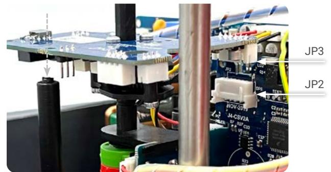
Introducirla hasta que el conector de la electrónica DPS (JP3) esté conectado con el conector (JP2) de la electrónica del actuador.
