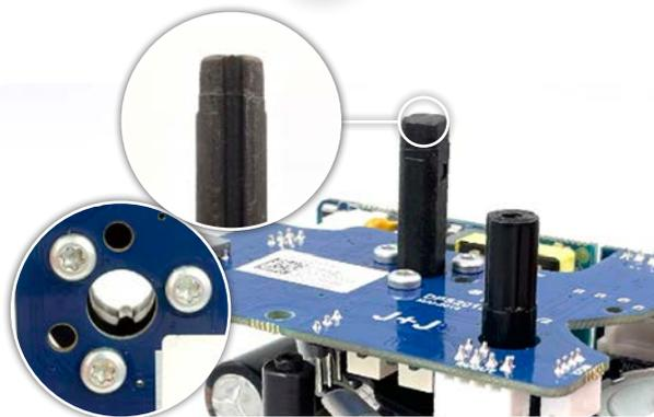
Montar la electrónica DPS (**Pieza C**), haciendo coincidir la hendidura del eje con la chaveta del engranaje central.
