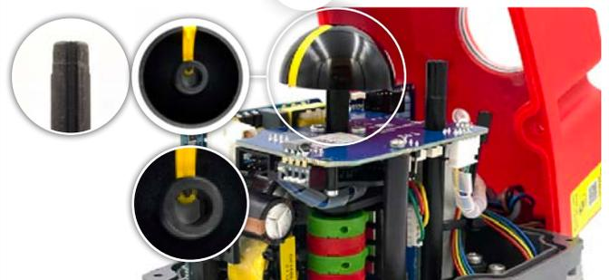
Insertar cuidadosamente el indicador visual de posición, haciendo coincidir la chaveta interior con la hendidura del eje.
