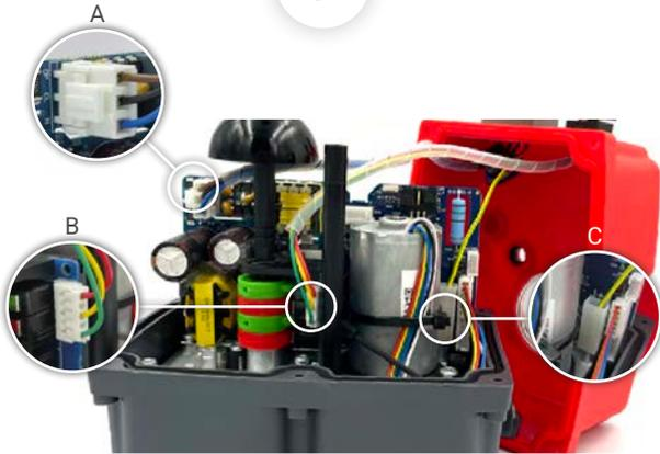
Coger la tapa del KIT DPS (**Pieza A**) y conectar el cableado según (Fig. A, B y C).
