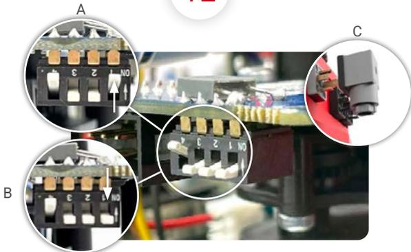
Subir el DIP 1 a posición ON (Fig. A), conectar corriente al conector gris de la tapa del actuador (Fig. C). Colocar el DIP 1 en la posición anterior (Fig. B) y esperar a que el actuador realice una maniobra completa. Desconectar la corriente del conector gris de la tapa del actuador.
