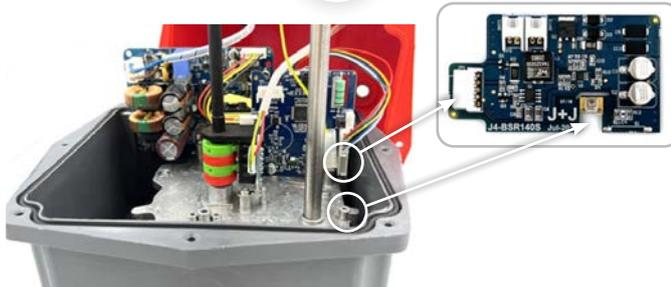
Enchufar la electrónica BSR (**Pieza A**) a la electrónica del actuador mediante el conector señalado en la figura.
