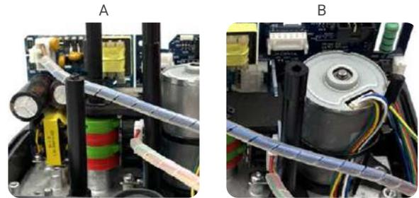
Situar el cableado de la tapa, según (Fig. A y B).
