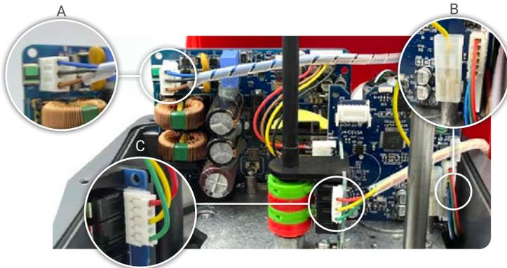
Desconectar el cableado de la tapa que está conectado a la electrónica. (Fig. A, B y C).
