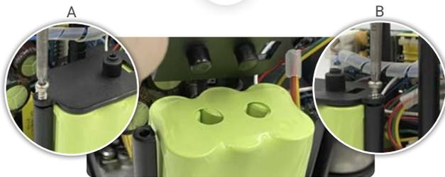
Colocar el soporte superior batería (Pieza D) y fijarlo a las columnas del soporte inferior batería (Pieza B) mediante 2 tornillos rosca plástico (Pieza F) (Fig. A y B).
