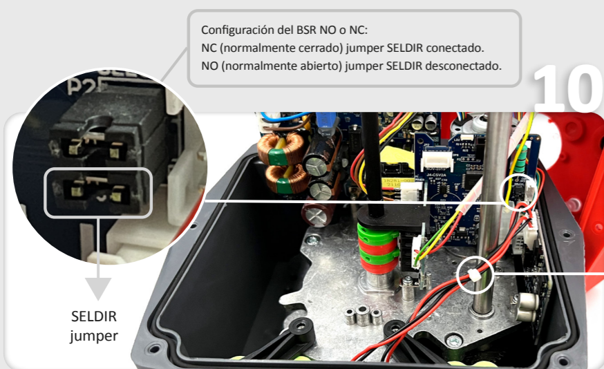
Fijar los cables de las 2 baterías (Pieza C) mediante la brida de plástico (Pieza E). Cortar el trozo de brida de plástico (Pieza E) sobrante.
