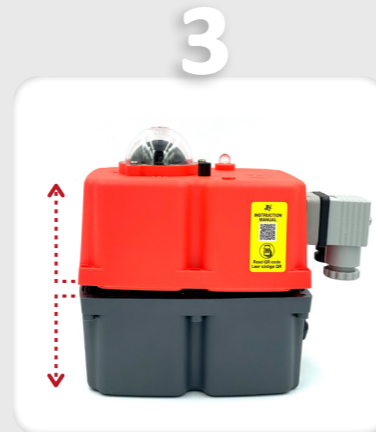
3 Separar la tapa de la base del actuador, para poder instalar el kit
