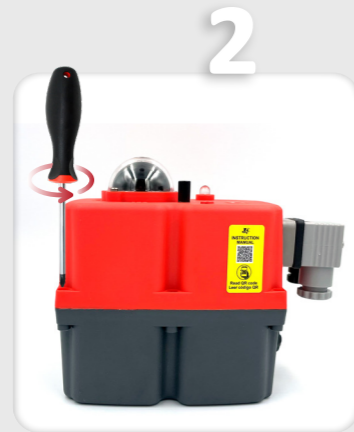
2 Desatornillar los 6 tornillos de unión entre la tapa y el cuerpo.
